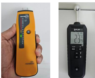
รูปที่ 2 เครื่องวัดความชื้นแบบทำลายพื้นผิว (ซ้าย) และ เครื่องวัดความชื้นแบบไม่ทำลายพื้นผิว (ขวา)
